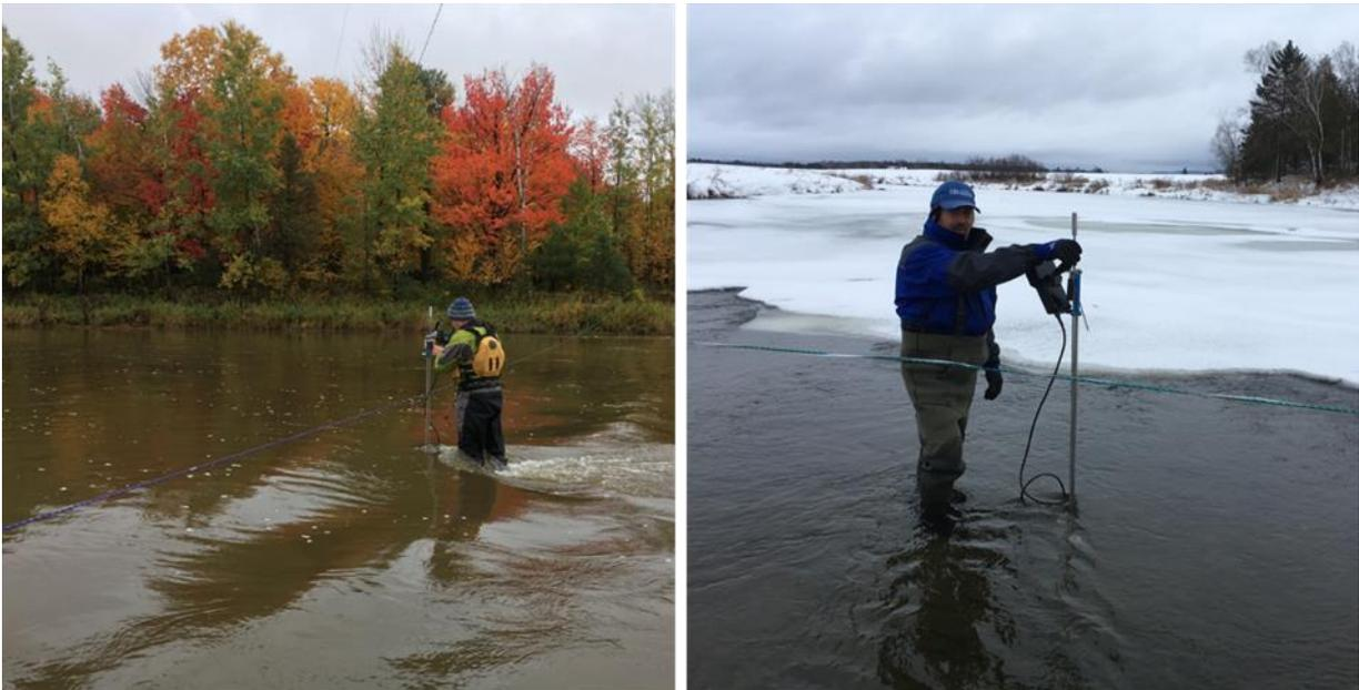
**Figure 5. Mesure du débit avec le courantomètre à la station Bulstrode à l'automne et au début de l'hiver 2018.**
