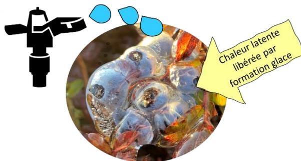
Figure 13. Schéma simplifié du principe physique lors de la formation de la glace, pour la méthode de protection de l'irrigation durant le gel.
