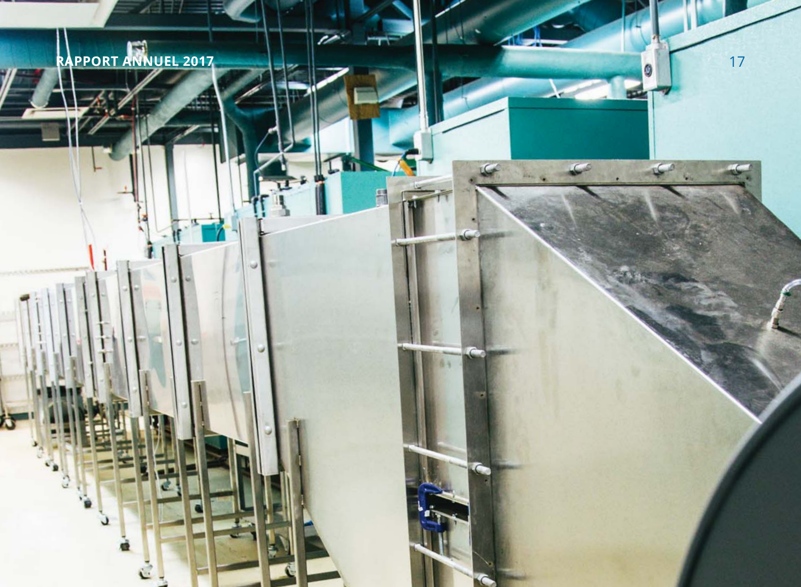
Une conception 100 % IRDA : deux équipements de laboratoire qui permettent de comparer l'efficacité de divers filtres pour bloquer les bactéries et les virus présents dans l'air.
