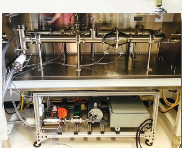
Une conception 100 % IRDA : deux équipements de laboratoire qui permettent de comparer l'efficacité de divers filtres pour bloquer les bactéries et les virus présents dans l'air.
