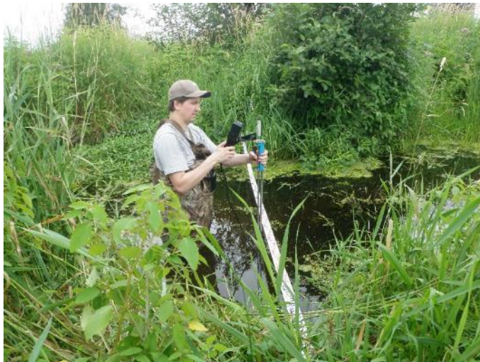
Figure 5. Mesures du débit instantané, à l'aide du moulinet hydrométrique, à la station Bouchard.
