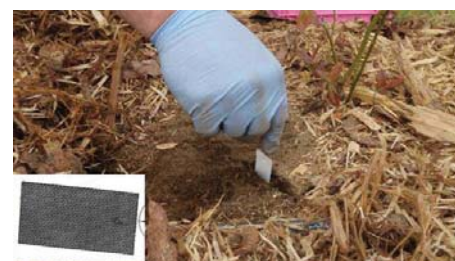
Membrane d'échange ionique pour la mesure des flux de N dans le sol
