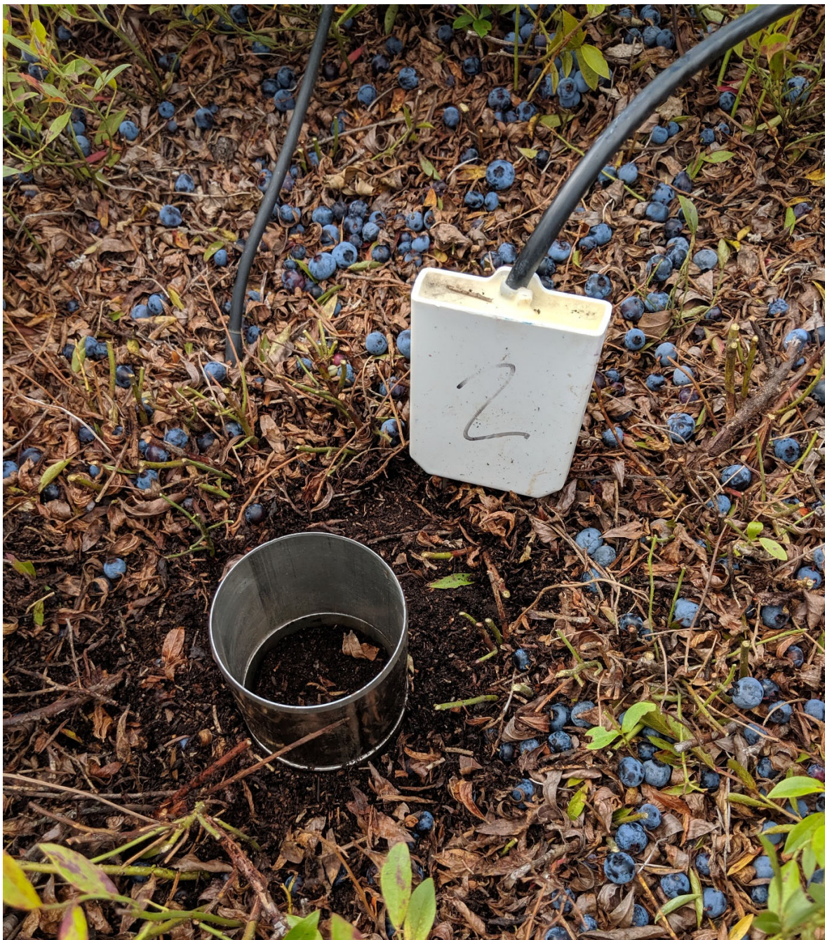
Figure 5. Prélèvement d'un cylindre de sol pour mesurer la masse volumique apparente. Le second cylindre sera utilisé pour enfoncer le premier à la profondeur voulue (2,5 à 4 po) afin d'éviter de compacter le sol – 28 août 2019.
