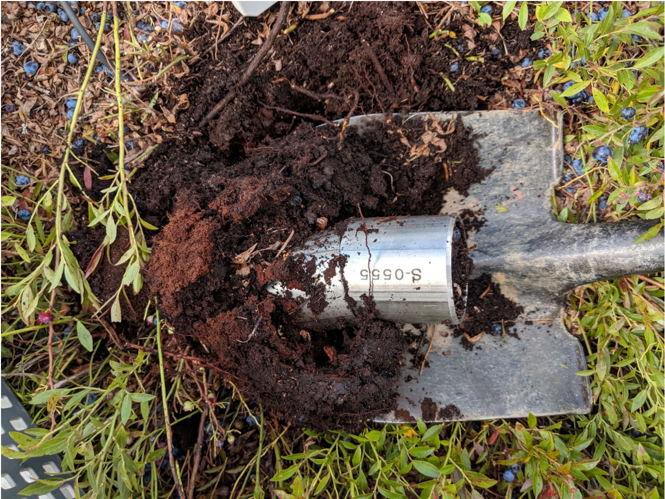
Figure 6. Les cylindres sont retirés du sol à l'aide d'une pelle – 28 août 2019.
