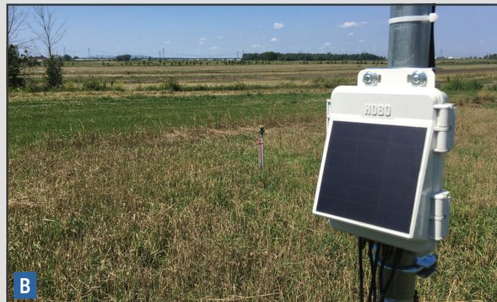
**Description :** Cet outil d'aide à la décision est composé de deux sondes de teneur en eau EC-5 (photo A) reliées à un enregistreur Micro RX2102 (photo B). Les 2 sondes de teneur en eau sont positionnées dans le sol à 20 et 40 cm de profondeur respectivement.
