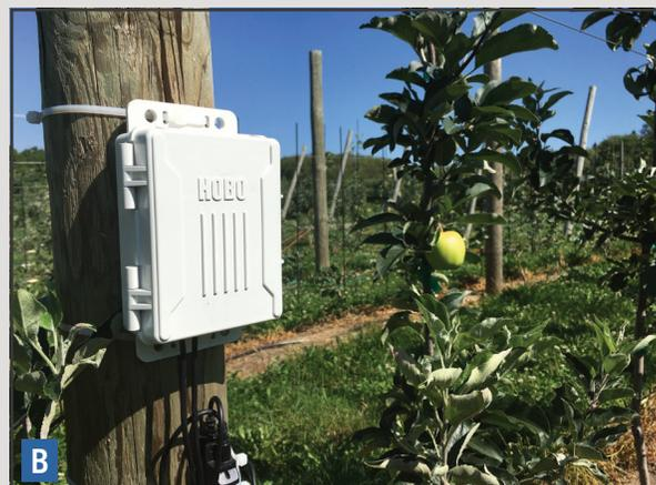
**Description :** Cet outil d'aide à la décision est composé de deux sondes de teneur en eau EC-5 (photo **A**) reliées à un enregistreur HOB0 H21-USB (photo **B**). Ce dernier est fixé à un poteau de palissage. Les sondes sont positionnées à 30 et 60 cm de profondeur sur la ligne de plantation. L'accès aux données est possible uniquement en se connectant par câble à l'enregistreur. Il faut donc être au site de mesures pour y accéder.
