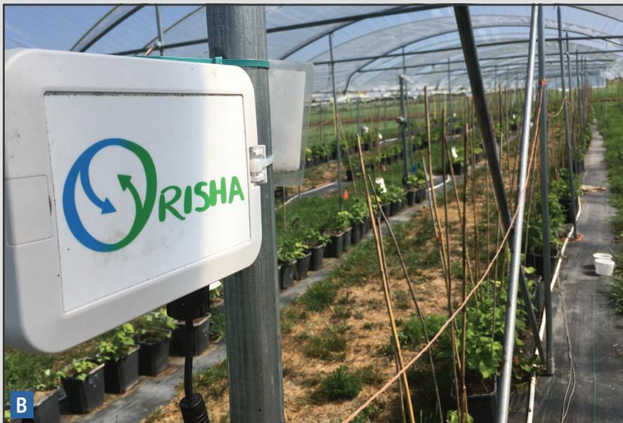
**Description :** L’outil d’aide à la décision comprend 2 tensiomètres de 12 pouces de longueur (photo **A**) qui sont reliés par câbles à différents boîtiers de contrôle (boîtier adaptateur tensiomètres, boîtier multifonction) et sans fil à un contrôleur central (photo **B**). Les boîtiers et contrôleurs doivent être fixés à un mur ou panneau à l’intérieur de l’abri ou de la serre. Pour être opérationnel, cet outil doit être branché à une prise électrique murale de 120 volts.
