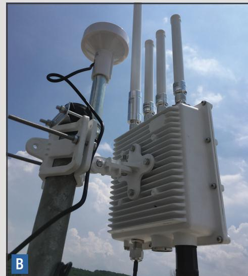
**Description :** Cet outil d'aide à la décision est composé d'un petit tensiomètre (photo A) qui communique à une antenne (photo B) située sur le toit d'un bâtiment au site de mesure. Le tensiomètre est positionné dans le substrat au centre du pot.
