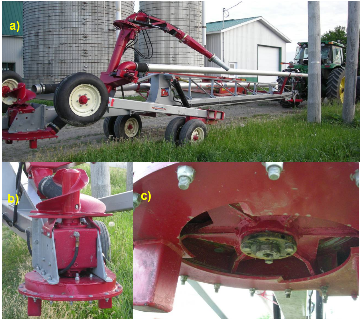
Figure 4 : Pompe DM utilisée lors des essais au site A (a). La pompe DM (PL300 32') est équipée d'une hélice verticale avec couteaux (b). La turbine horizontale est munie de six couteaux à l'entrée et d'un couteau à la sortie (c).
