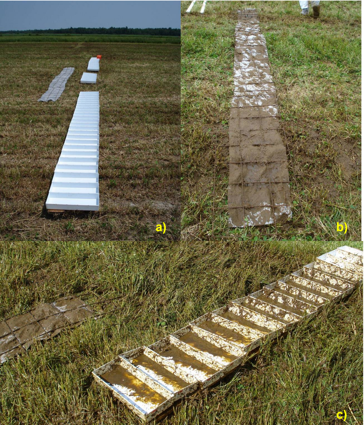
Figure 17 : Dispositif de mesure a) dans son ensemble, b) après un épandage sur les tissus absorbants et c) dans les bacs.
