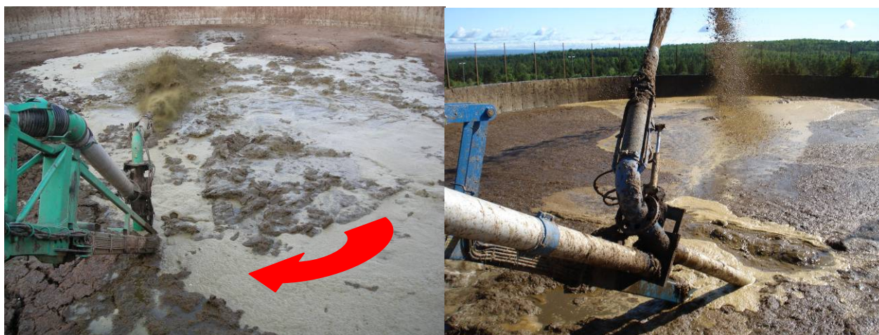
Figure 18 : a) Amorce du mouvement des matières solides dans la fosse vers la pompe Houle, b) inefficacité de la pompe Pro-Jet dans un lisier trop clair.
