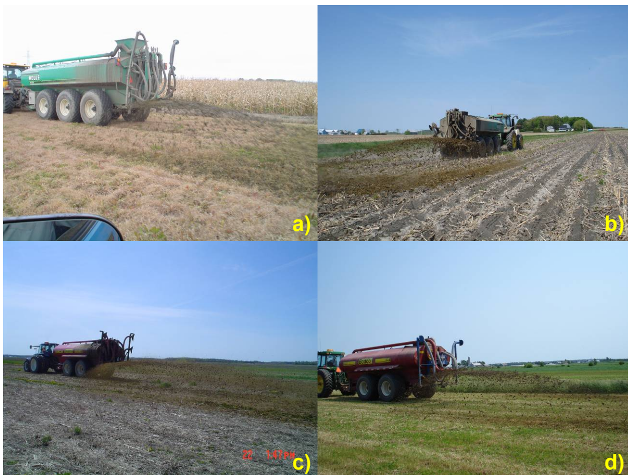
Figure 42 : Images d'épandage de lisier à contenu élevé en matière sèche réalisé avec l'aéroaspersion basse.
