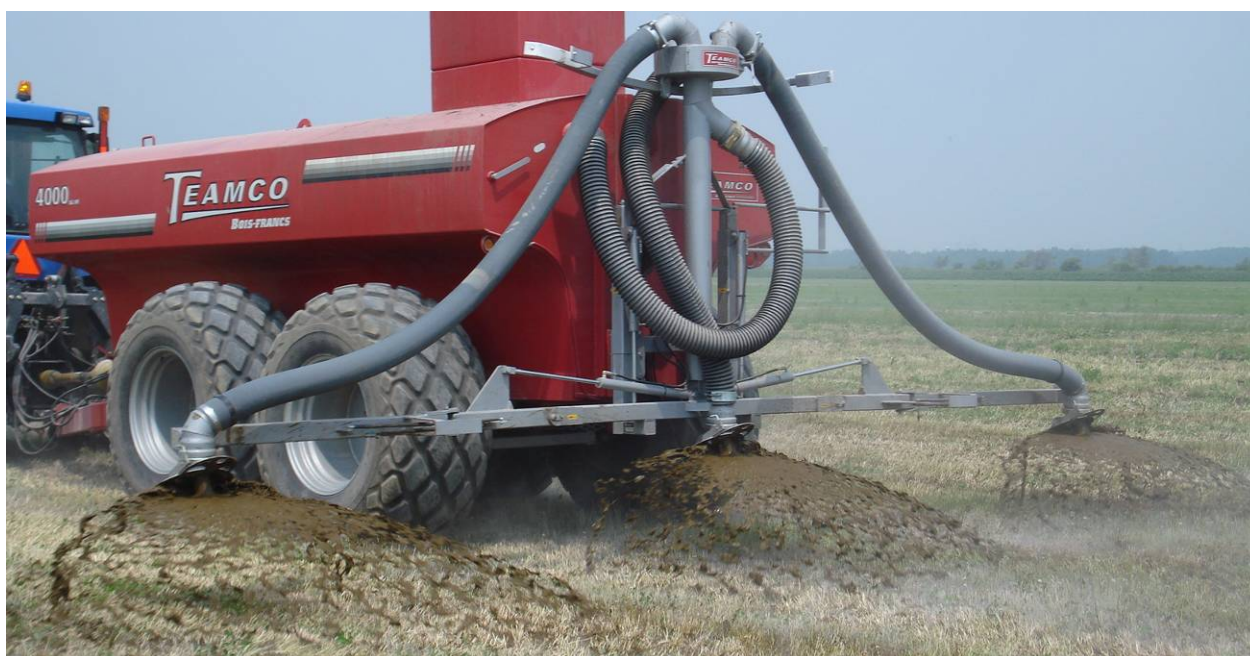
Figure 10 : Rampe à 3 jets Teamco opérant au site C.
