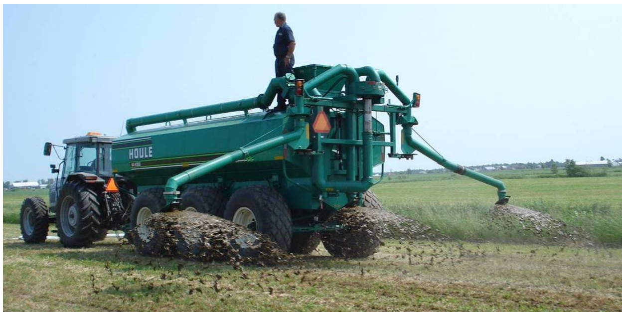
Figure 7 : Rampe à 3 jets Houle opérant au site A.
