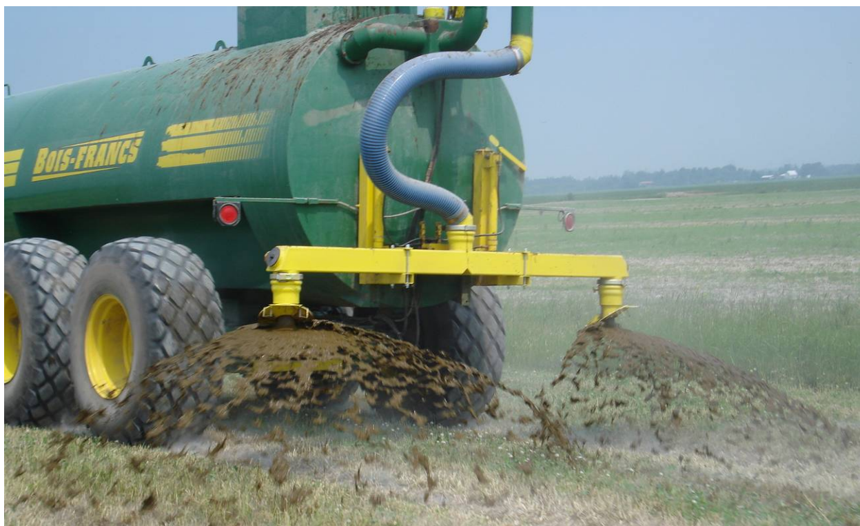
Figure 8 : Rampe à 2 jets Maddington opérant au site C
