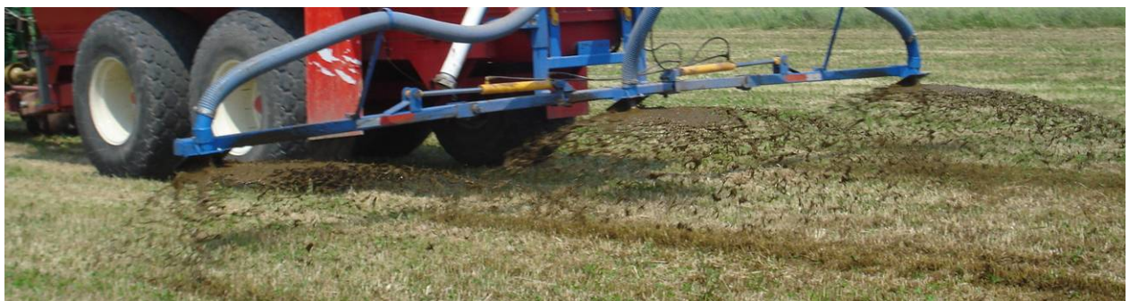
Figure 24 : Vue de la rampe Pro-Jet et de son jet de gauche bloqué partiellement par des fibres de paille et de foin
