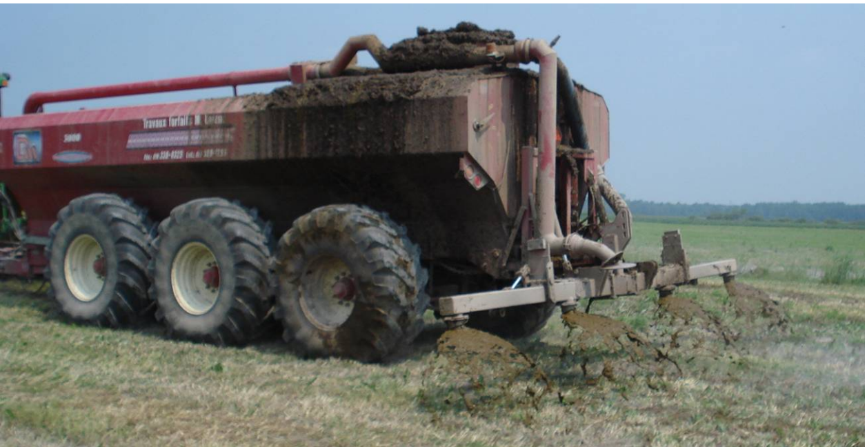
Figure 12 : Rampe à 4 jets DM opérant au site C
