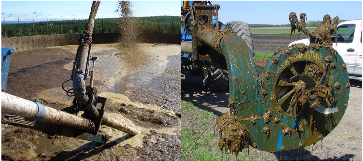
Figure 5 : Pompe Pro-jet utilisée lors des essais au site B. La pompe Pro-Jet (19") possède une turbine verticale munie de couteaux à la sortie, de blocs pour la restriction dans la turbine et d'une hélice à l'entrée de la turbine. La turbine possède 2 sorties placées à 180° l'une de l'autre qui se rejoignent dans le même canon.
