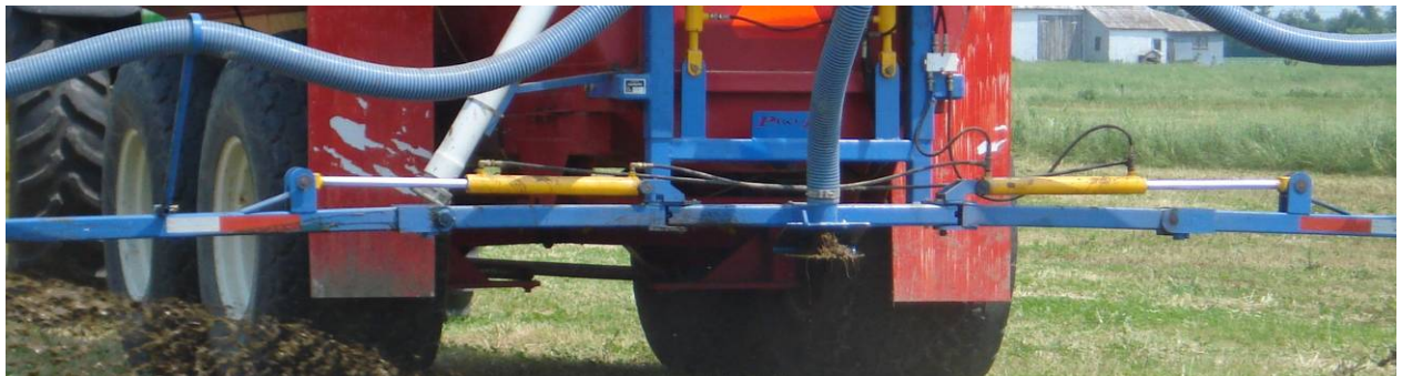
Figure 23 : Vue de la rampe Pro-Jet et de son jet du centre bloqué par des fibres de paille et de foin
