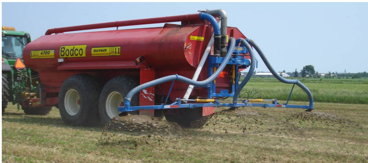
Figure 9 : Rampe à 3 jets Pro-Jet opérant au site A.
