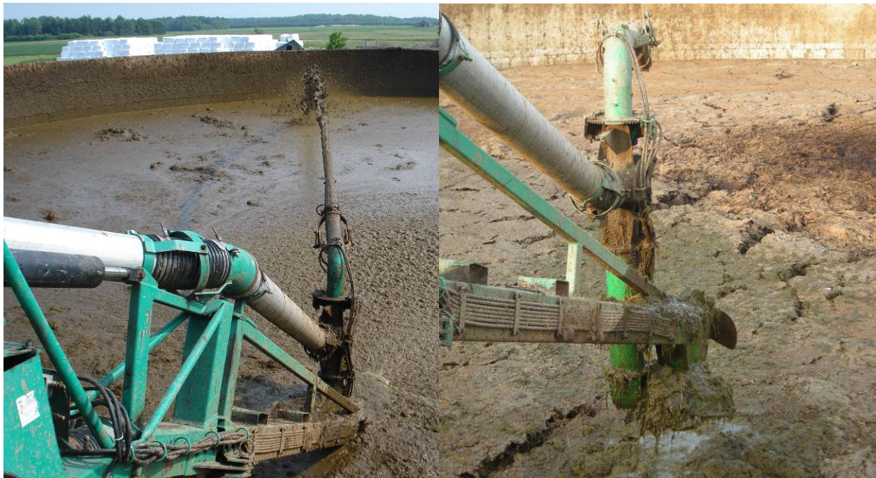
Figure 6 : Pompe Houle utilisée lors des essais au site C. La pompe Houle (Agi-pompe) possède une hélice horizontale munie de couteaux, ainsi qu'une turbine horizontale munie de couteaux à l'entrée et à la sortie.
