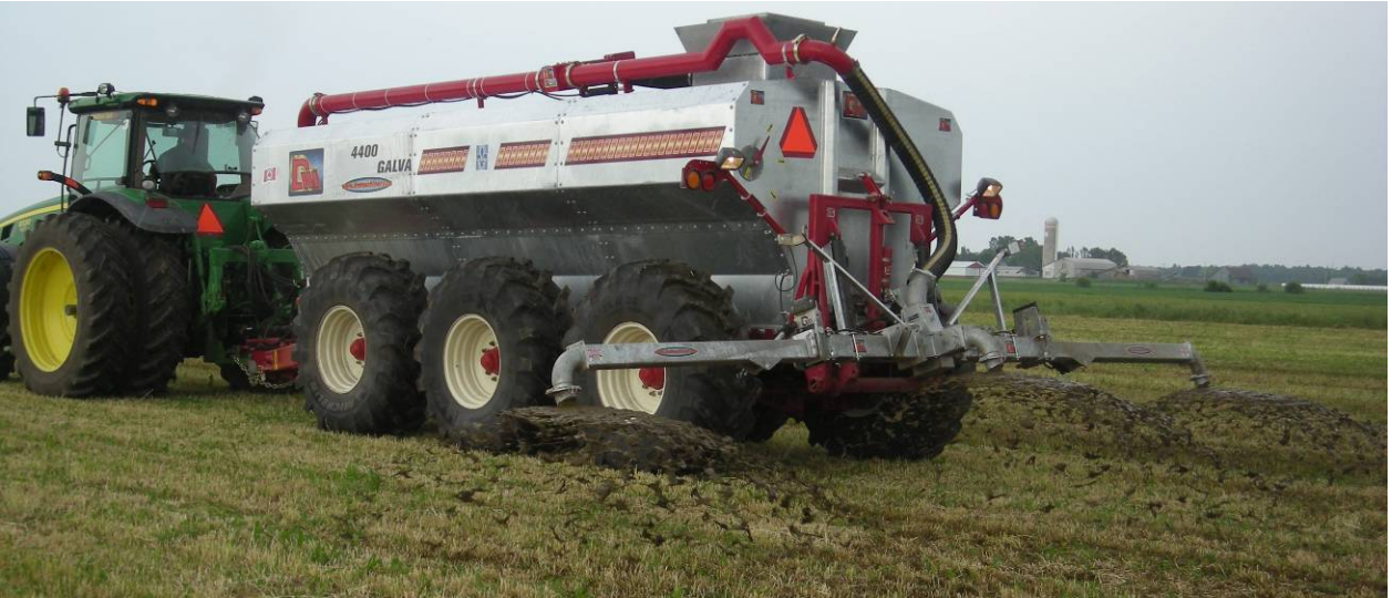
Figure 11 : Rampe à 3 jets DM opérant au site A.
